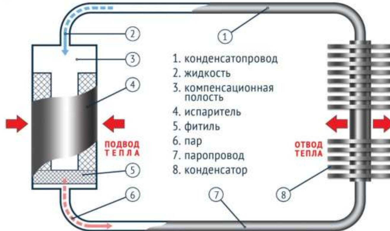
Теркон<sup>®</sup> КТТ позволяет избавиться от блока вентиляторов и радиатора процессора
